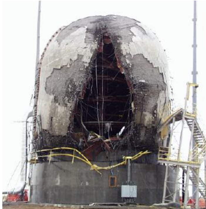
Abbildung 1: Versagen des Sicherheitsbehälters beim Maßstabexperiment 1:4 (Sandia National Laboratories, 2003)
